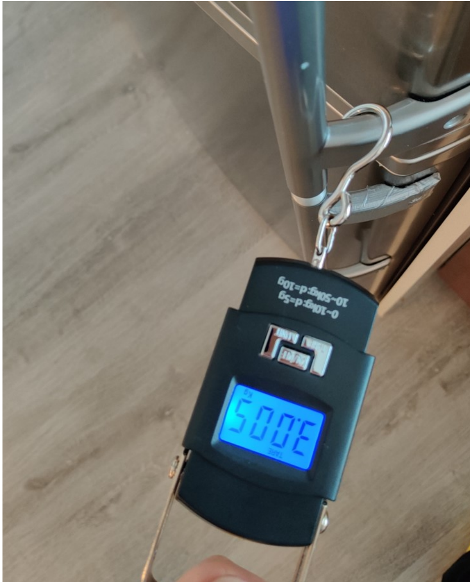
Kuva 8. Oven avausvoiman mittaus kahvaa kulmassa vedettäessä.
