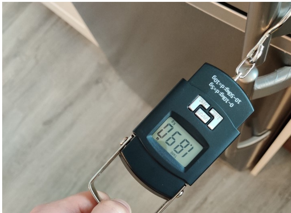
Kuva 7. Oven avausvoiman mittaus juuri ennen oven avautumista suoraan ulospäin vedettäessä.
