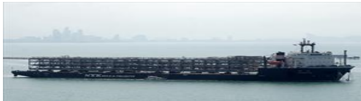
Figur 4. Tunglyftfartyget Yamato med Mitsubishi tryckluftsanordning installerad (Marinetraffic, 2015)
