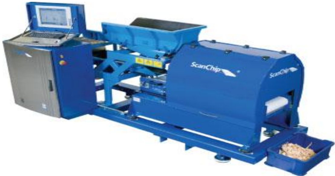
Kuva 9. Iggersund Tools:in ScanChip online-mittalaite. (10)
