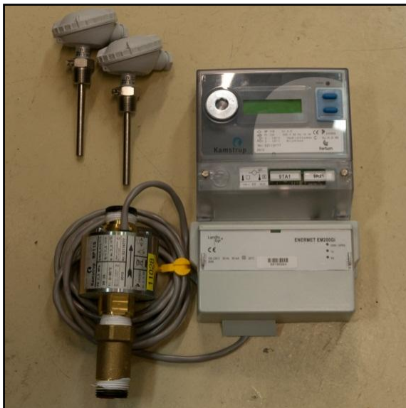
Kuva 1. 9EVL Kaukolämpömittari ja EM200Gi Modeemi.
