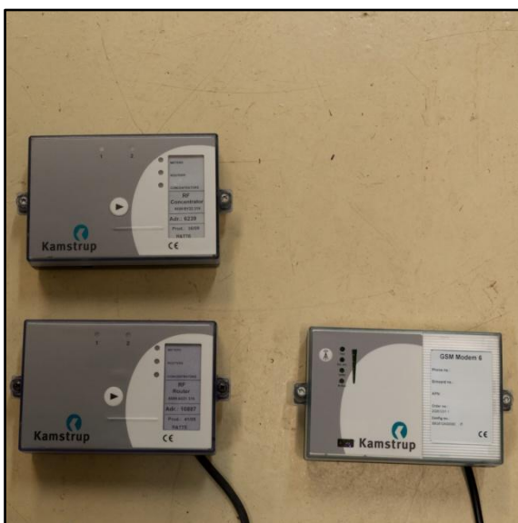
Kuva 9. Radioverkon laitteita: keskitin, reititin ja modeemi.
