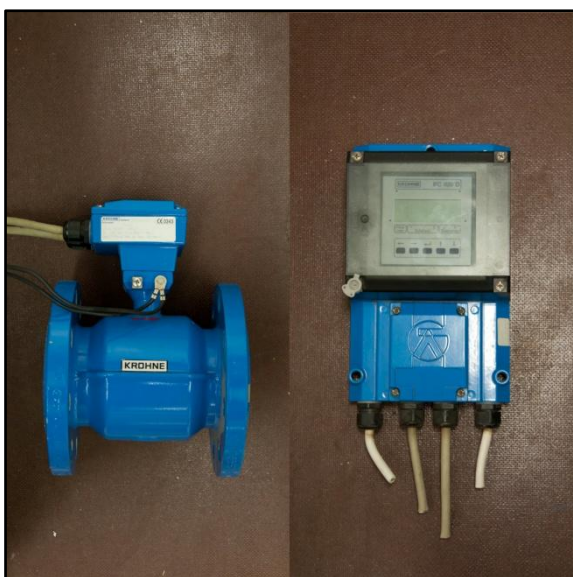
Kuva 3. Asiakkaalta poistettu Krohne virtausanturi ja laskijalaite.
