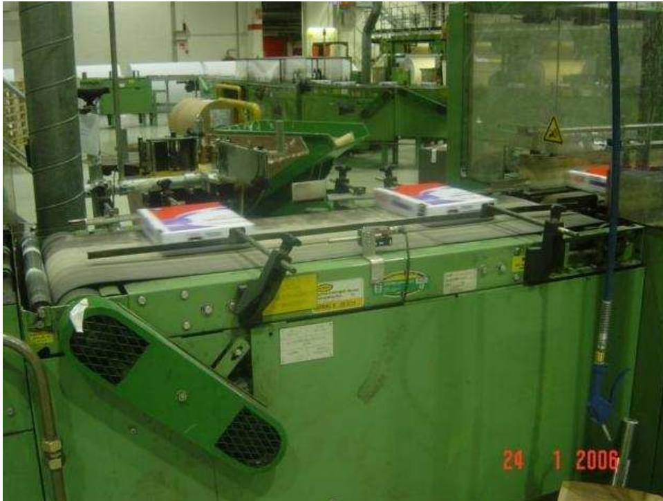
Kuva 12. Siirtokuljetin, jonka paikalle jälkilämmityskuljetin tulee
