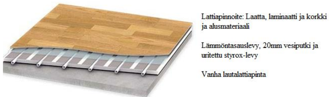
KUVA 5. Vesikiertoinen lattialämmitys rakenne kohteen keski- ja yläkerroksessa./13
