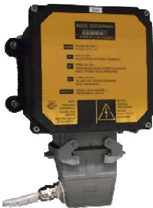
Kuva 14. Radion vastaanotin (radio) kiinnitetään levyyn usein M6-pulteilla
