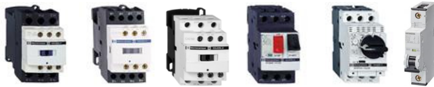
Kuva 8. Pienet kontaktorit, apukontaktorit, GV2-tyyppiset moottorisuojat, erilaiset releet sekä johdonsuojakatkaisijat kiinnittyvät pikalukituksella din-kiskoon; Din-kiskoon kiinnittyviä komponentteja on useita erilaisia
