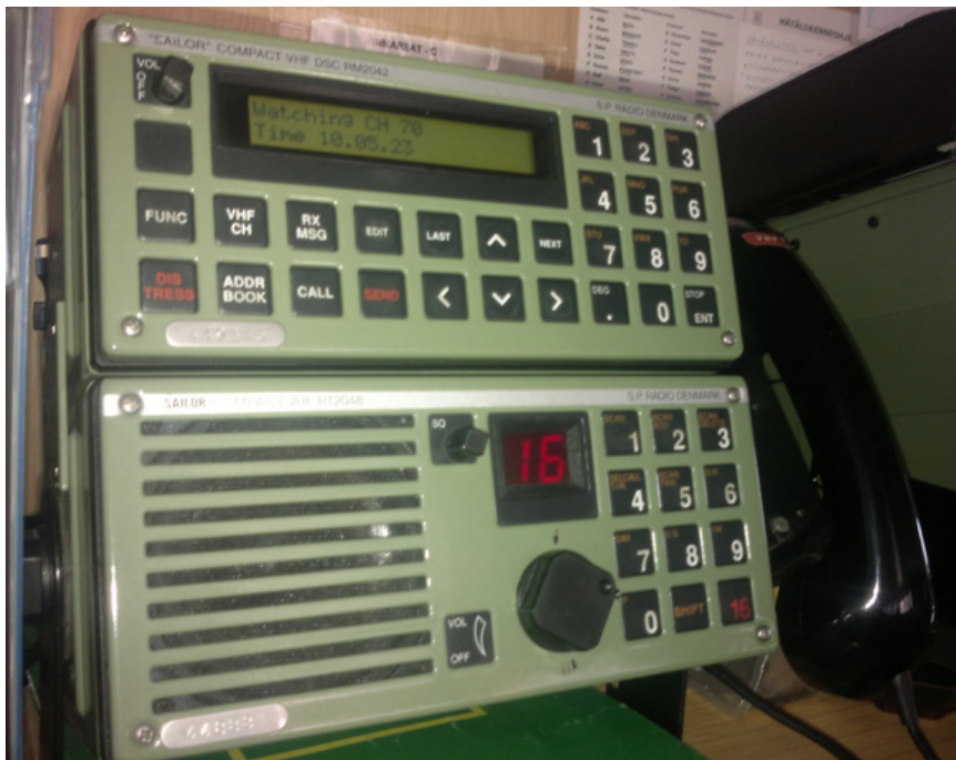
Kuva 2. Koululaiva Katarinan VHF-DSC-laitteisto
