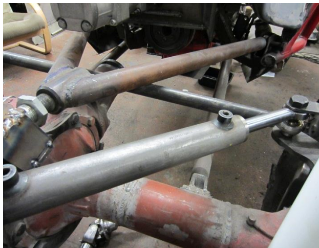
Kuva 12. Etuakselin tukivarret ja ohjaussylinteri.
