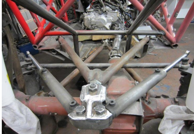
Kuva 11. Taka-akselin kolmiotuet ja ohjaussylinteri.
