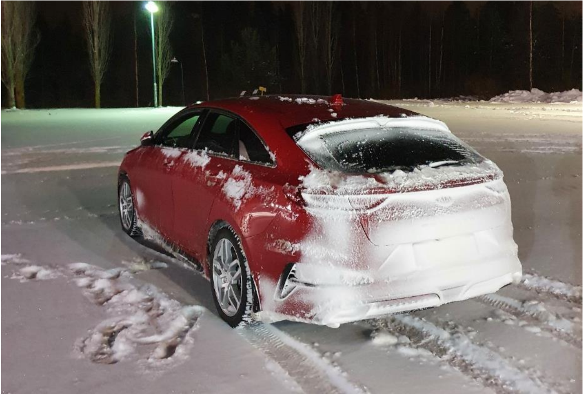
Kuva 5. Kuvassa nähtävissä kuinka led-valo ei tuota lämpöä ja takavalot muurautuvat helposti lumesta umpeen. (kuva: Mika Huhtasaari).
