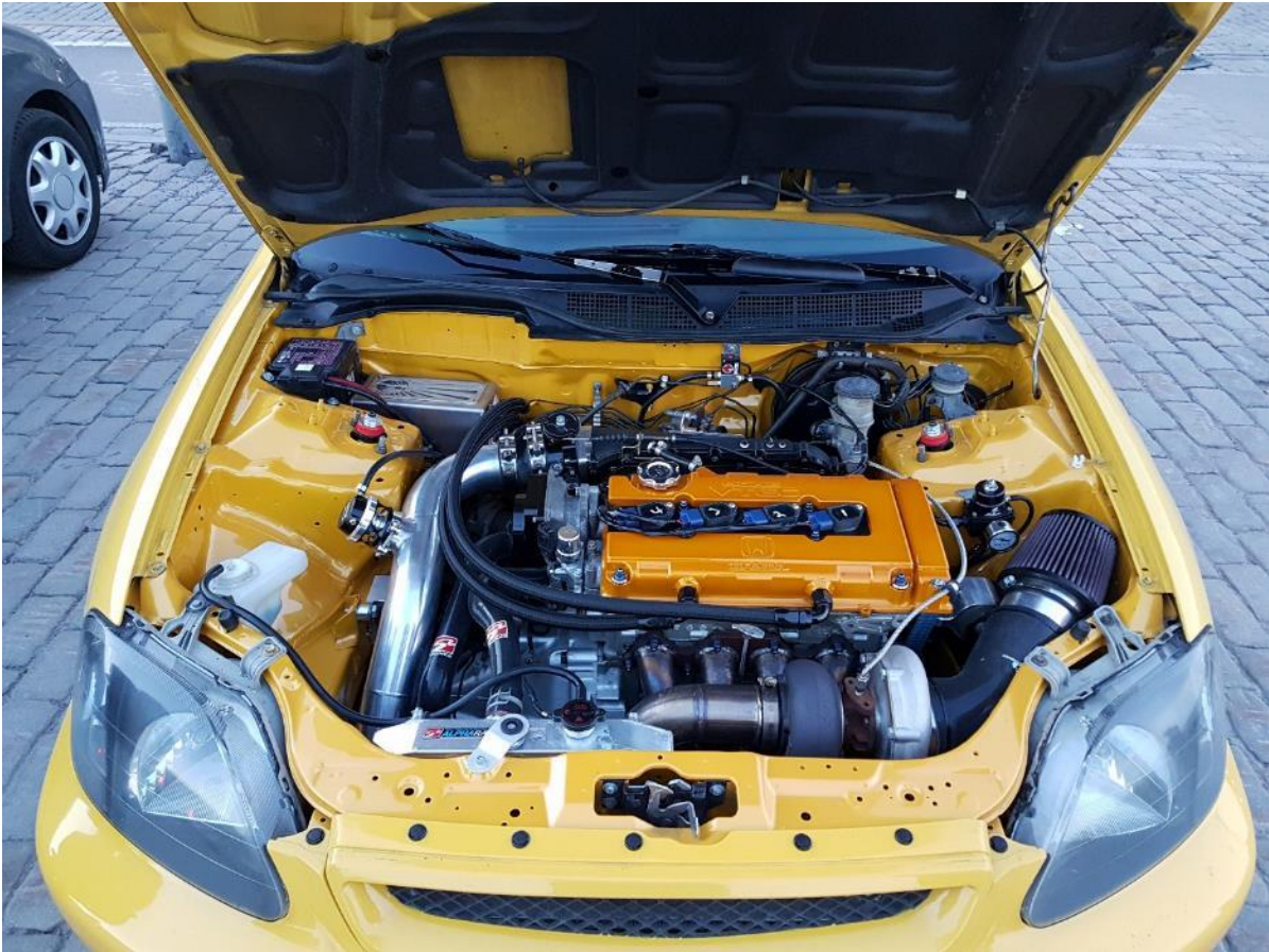
Kuva 37. Kuvassa Honda Civic, jonka moottoriin asennettu jälkikäteen turboahdin. (kuva: Mika Huh-tasaari)
