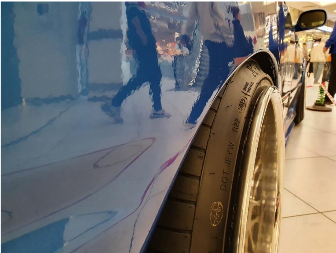
Kuva 22. Kuvassa tyypillinen rengas-vanneyhdistelmä, jossa leveälle vanteelle asennetaan huomattavan kapea rengas. (kuva: Mika Huhtasaari)
