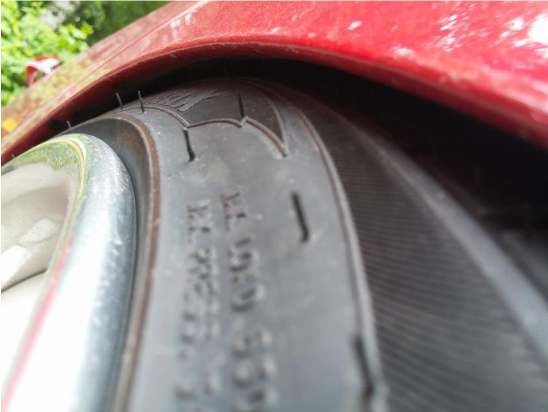
Kuva 23. Kuvassa rengas pyritty tuomaan mahdollisimman lähelle lokasuojan kaaren reunaa (kuva: Mika Huhtasaari).
