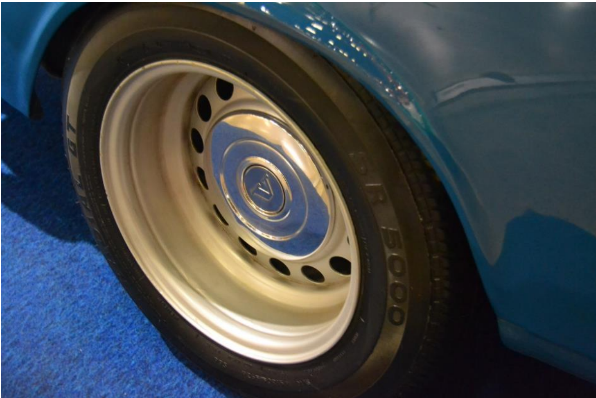
Kuva 19. Kuvassa levitetty peltivanne. Kuvan yksilö on toteutukseltaan hyvin tehty, joka voi olla vaikea havaita liikennevalvonnan yhteydessä. (kuva: Mika Huhtasaari)
