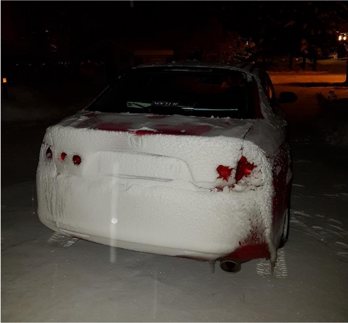
Kuva 4. Kuvassa nähtävillä kuinka hehkulankapolttimon tuottama lämpö sulattaa takavalojen päälle kertyneen lumen. (kuva: Mika Huhtasaari).
