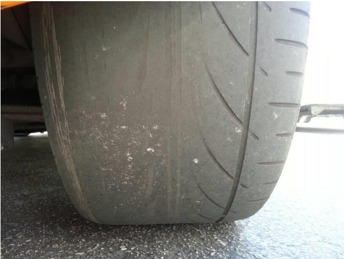
Kuva 33. Kuvassa renkaan kulutuspinnan kuluminen, joka on aiheutunut liiallisesta negatiivisesta camber-arvosta. (kuva: Lotustalk.com).
