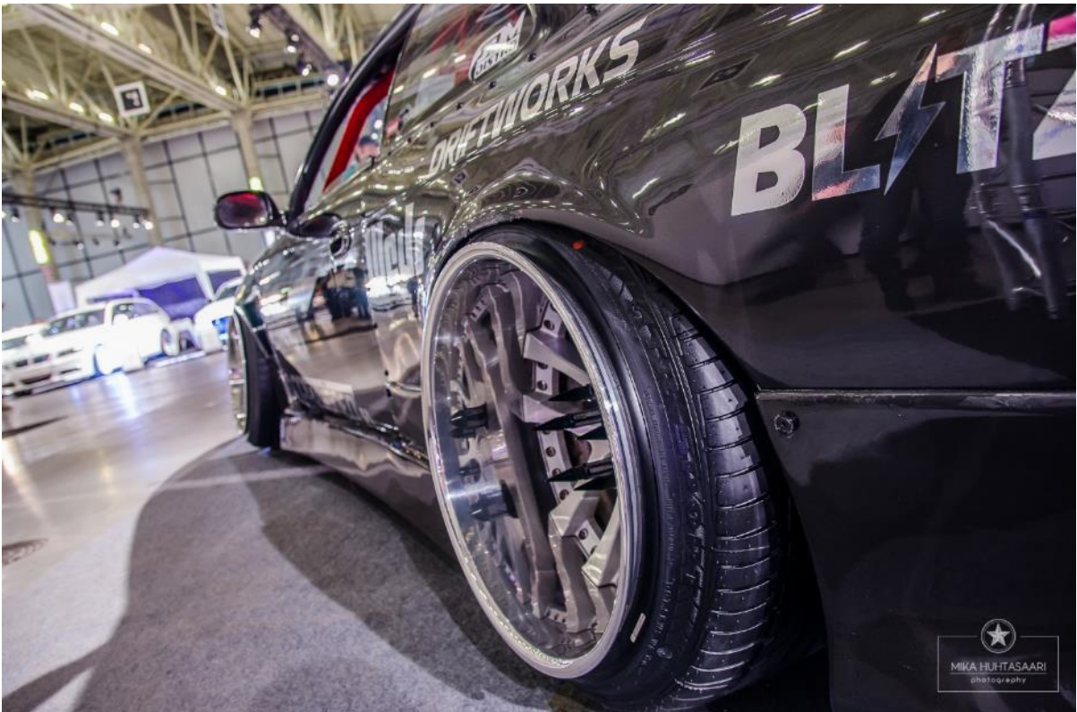
Kuva 17. Kuvassa tyypillinen rengas-vanneyhdistelmä, jossa leveälle vanteelle asennetaan huomattavan kapea rengas. (kuva: Mika Huhtasaari)
