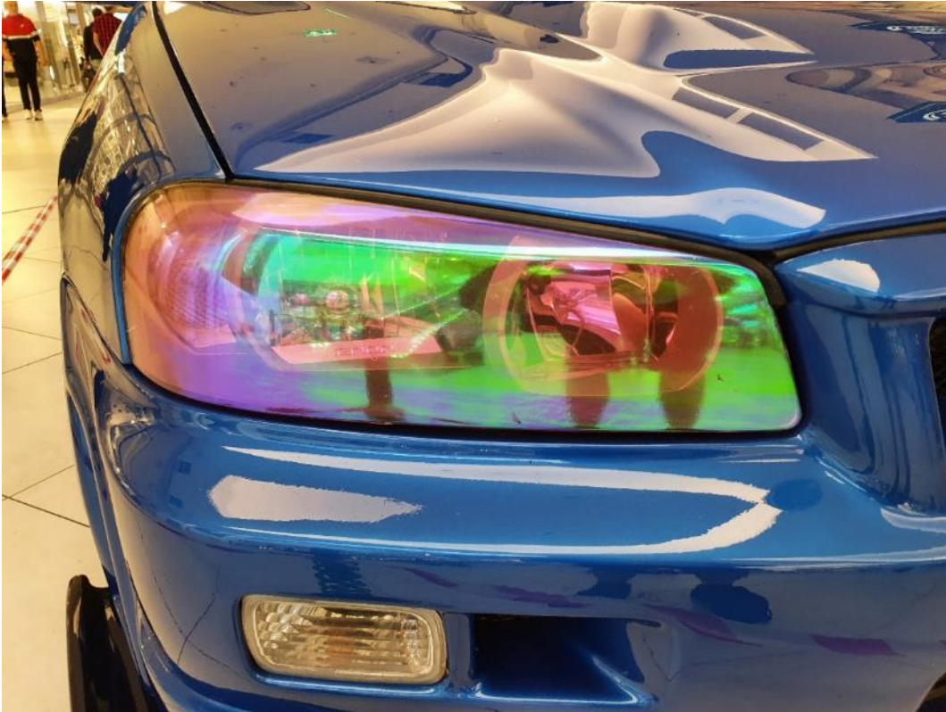
Kuva 26. Kuvan auton ajovaloihin asennettu "sateenkaaren"-värinen kalvo. (kuva: Mika Huhtasaari)
