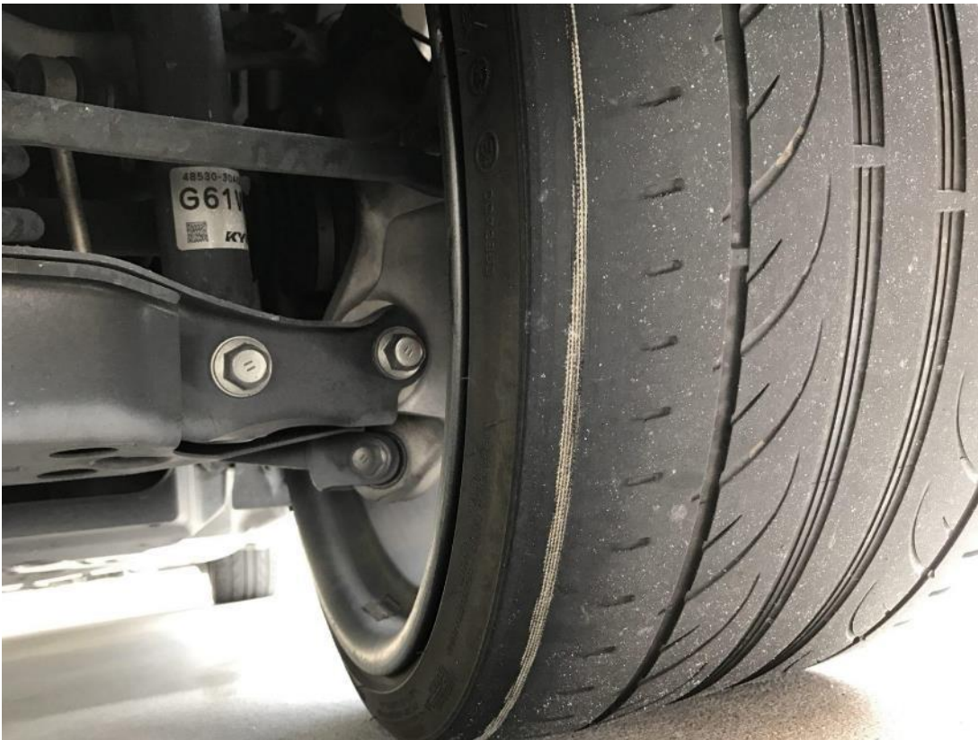
Kuva 36. Kuvassa renkaan vaurio, jossa renkaan sisempi ulkoreuna kulunut sisärakenteeseen asti negatiivisen camber-arvon vuoksi. (kuva: Carfromjapan.com.)
