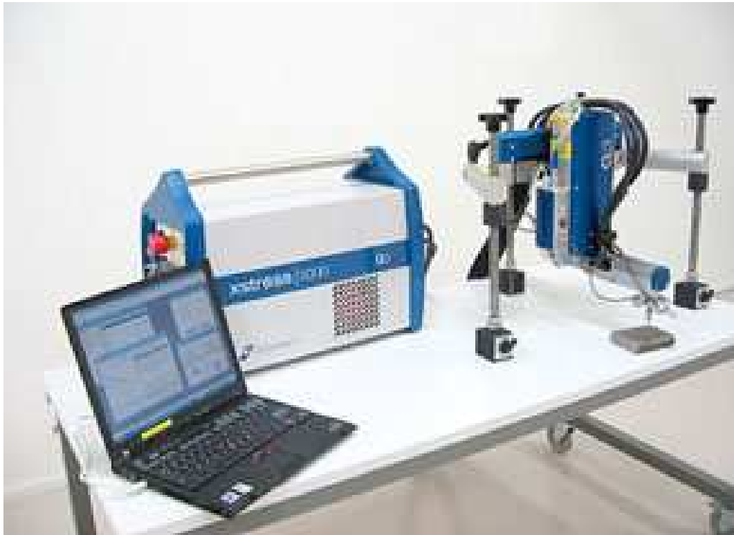
KUVIO 2. XSTRESS 3000 -keskusyksikkö ja G3-goniometri (Stresstech 2012)
