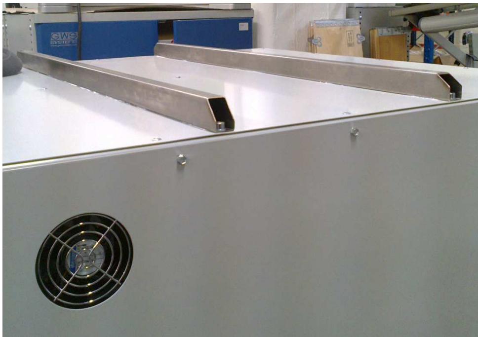
KUVIO 24. Katon jälkiasennetut tukipalkit
