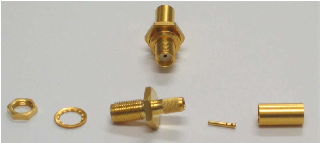
KUVA 12. Ylhäällä SMA-naarasliitin valmiina, alhaalla ennen kokoamista (Kuva: paratronic.fi, 7)
