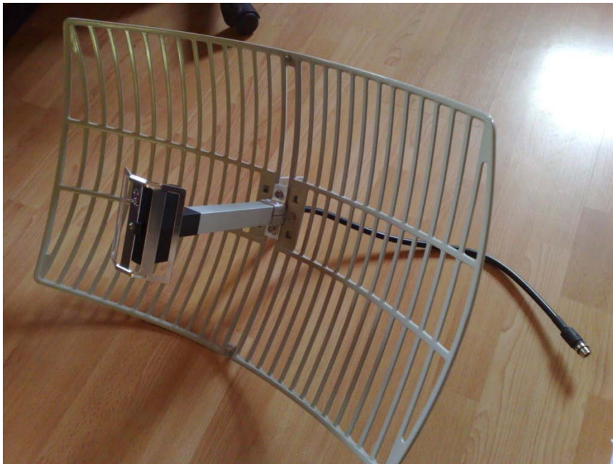
KUVA 7. 3G-antenni koottuna (Kuva: Lassi Rautiainen 2011)
