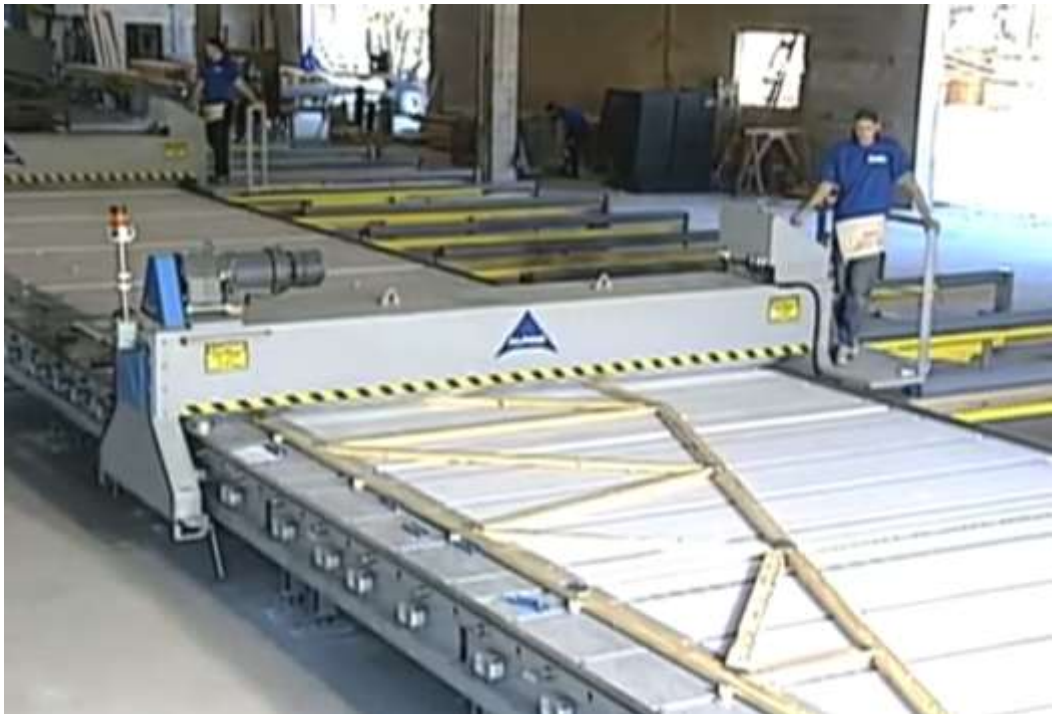
KUVIO 22. RAM EasyRider -puristin liikkuu ja puristaa naulalevyt (Alpine Equipments 2008 - 2010)
