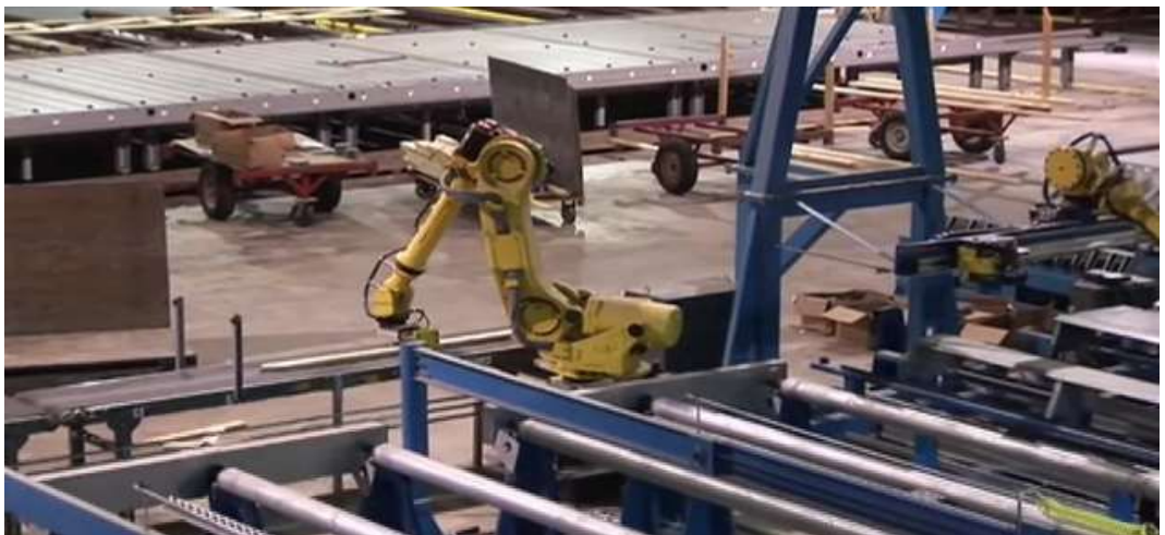
KUVIO 30. Robotti ottaa osan ja siirtää sen pöydälle oikeaan kohtaan (TCT Automation 2012)
