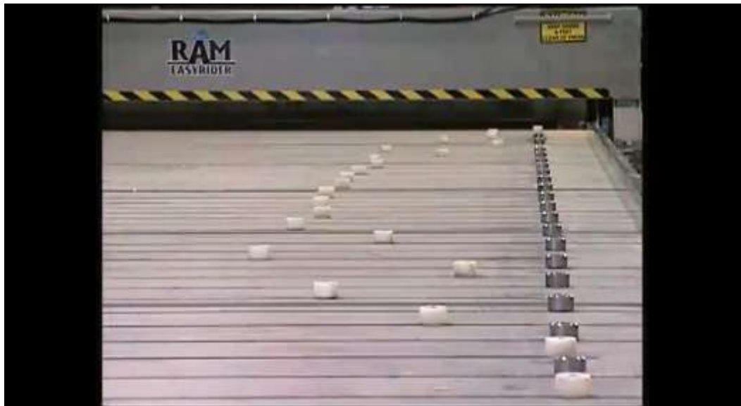
KUVIO 20. Asete muodostuu kiekkojen sijoittamisella (Alpine Equipments 2008 - 2010)
