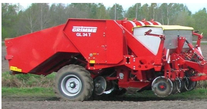
Figur 2. Potatissättare med gödselaggregat. Gödselbehållaren och gödselbillarna är monterade framme på potatissättaren. (Norrvik 2011)
