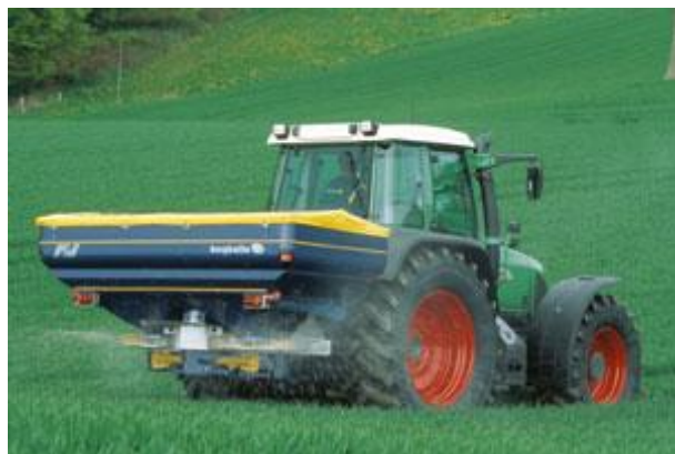
Figur 1. Bredgödelspridare av modellen centrifugalspridare.(Lantmännen maskin u.å.)
