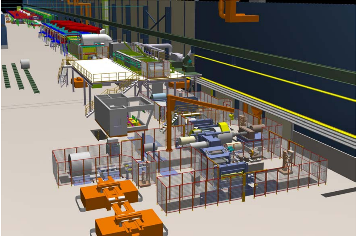
Kuva 5. HP2-linjan alkupää, rasvanpoisto, hehkutusunit ja peittäus
