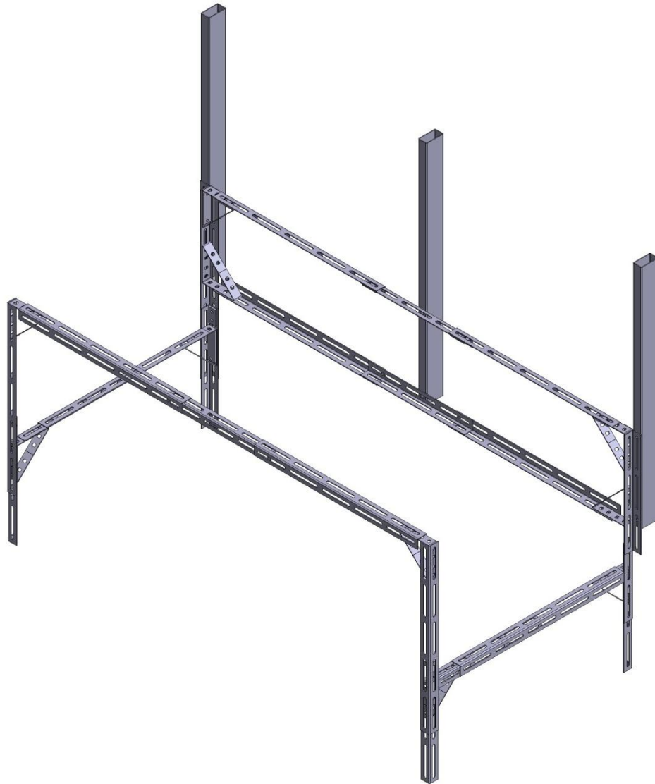
Kuva 32. Rungon kokoonpano 1500 x 750 mm kokoiselle pöytälevylle
