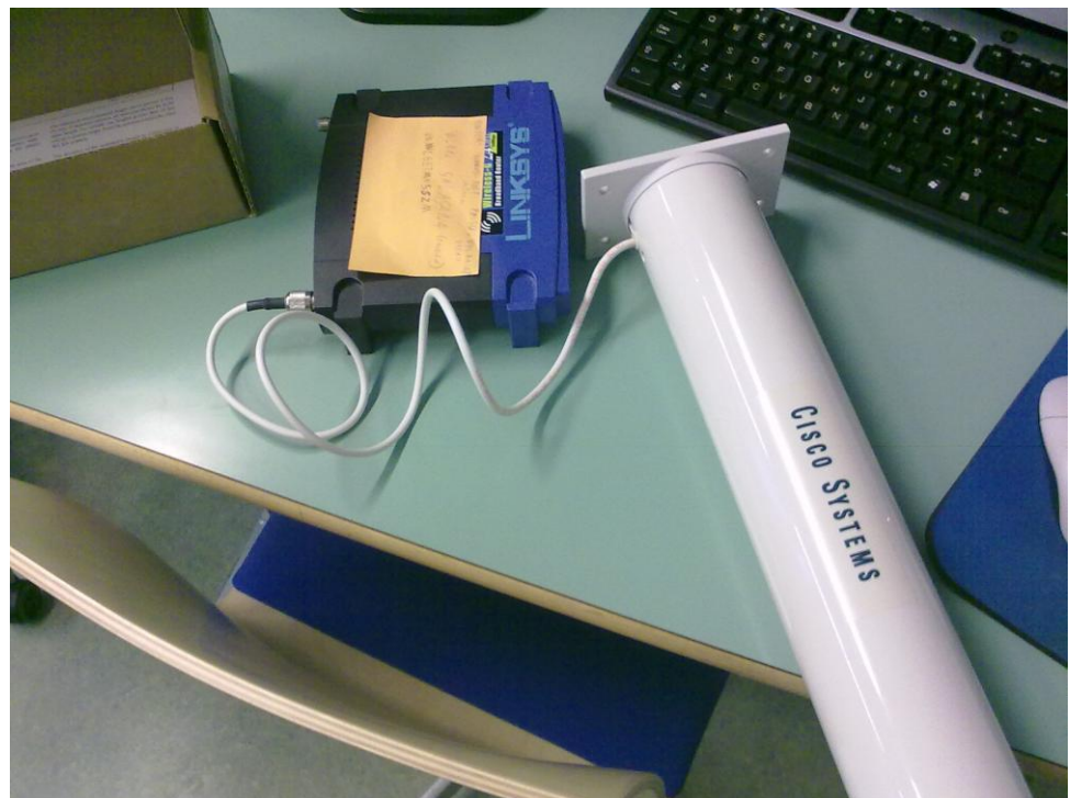
kuva 21. Yagi-antenni kytkettynä reitittimeen
