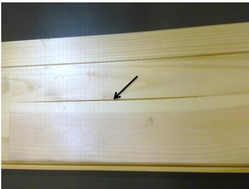
KUVA 9. Kappaleen alkuperäinen hylkäykseen johtanut materiaalivika
