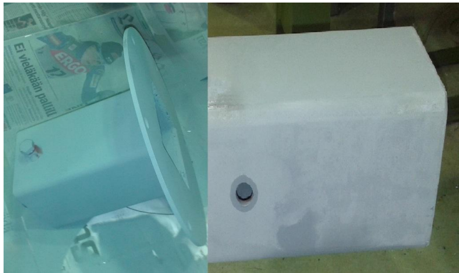
Kuva 5. Windside -tuuliruuviturbiinin kiinnitysholkki ja mastoon lukitus
