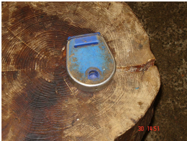
KUVIO 2. Transponder, eläimen tunnistuksessa käytettävä laite (Räty 2007)
