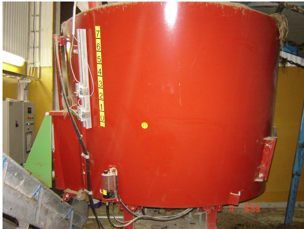
KUVIO 11. Paikalleen asennettu kiinteä seosrehusekoitin (Räty 2008)
