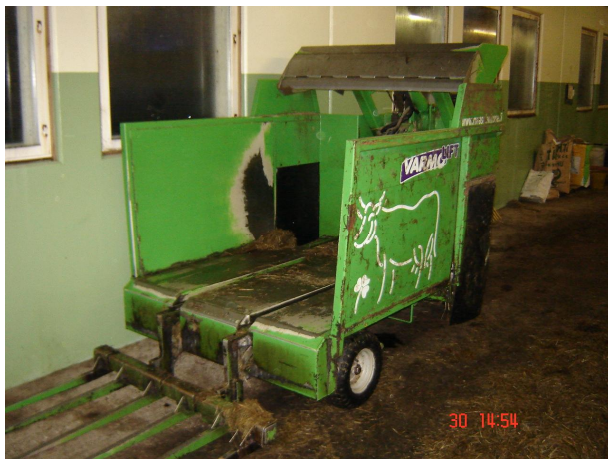
KUVIO 4. Leikkuuterällä varustettu dieselmoottorinen säilörehunjakovaunu (Räty 2007)
