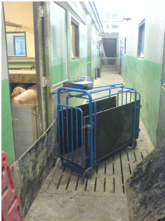
KUVIO 19. Painomittaukseen sopiva digitaalinen maatilavaaka
