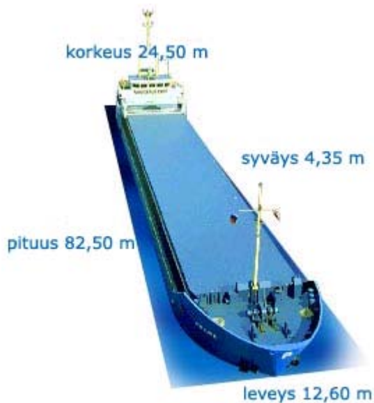
Kuva 10. Saimaan kanavaan mahtuvan aluksen maksimimitat (Merenkulkulaitos)
