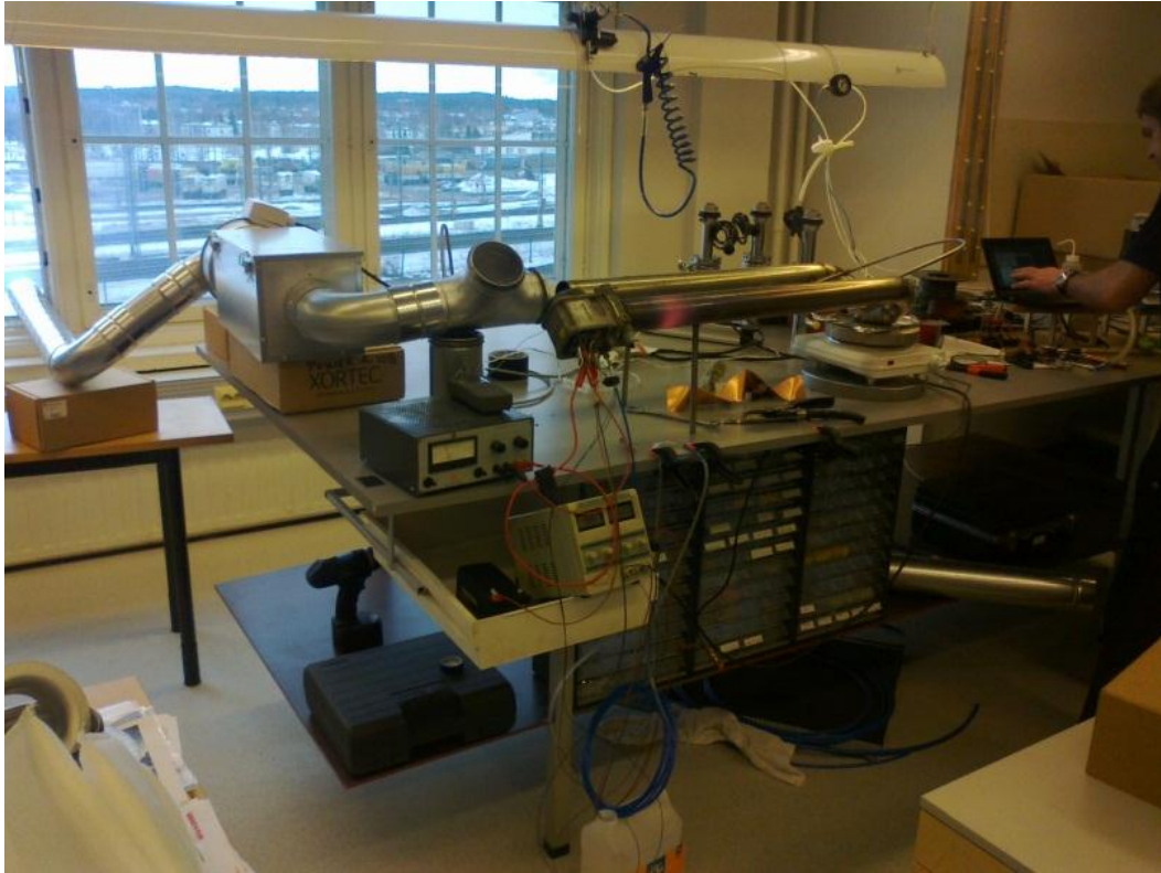
Kuva 8: Nokeamislaitteisto. Kuvassa näkyy lämmityslaitteen jälkeinen pakoputken kohta punahehkuisena. Kuvassa oikealla on viistoleikattu taitekohdan aukko valkoisenlämmityslevyn päällä.
