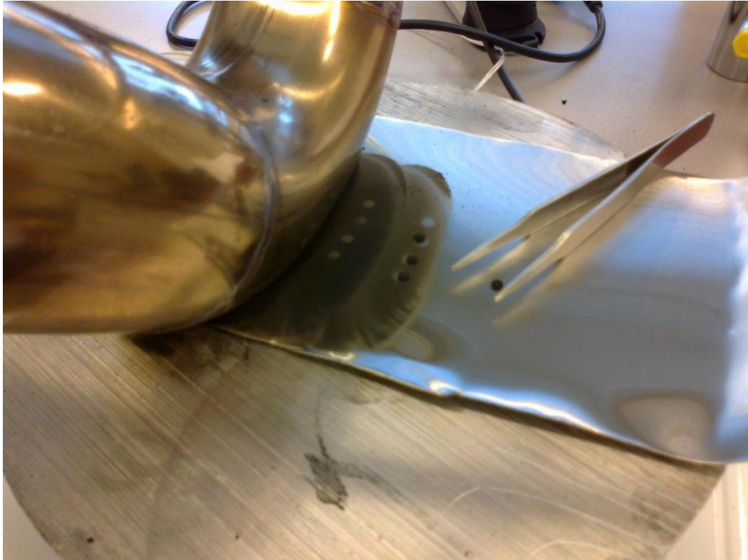
Kuva 9: Nokeamislaitteen pakoputki on viistoleikatusta taitekohdastaan teräslevyn päällä ja teräslevy alumiinisen lämmityslevyn päällä. Teräslevyllä on pakoputken sisällä olleita koekappaleita valmiiksi noettuina, joista yksi koekappale on siirretty paremmin näkyville pinseteillä.
