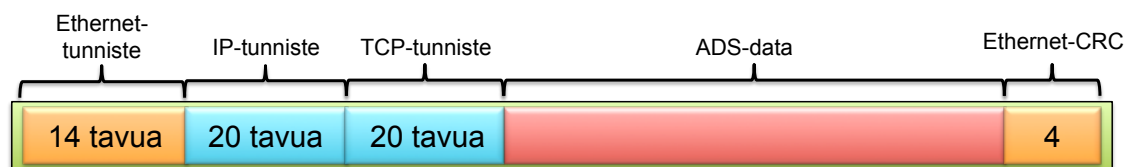
KUVIO 17. TCP/IP-koodattuun Ethernet-kehikseen sisällytetty ADS-koodattu data
