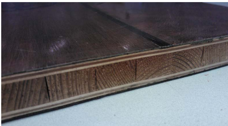
Kuva 15. Kahden vanerilevyn väliin puristettu mäntyrimapohja. (Omat kuvalähteet)
