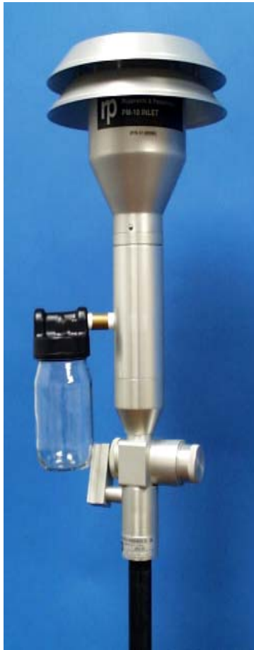
Kuva 12. TEOM 1400 a PM_{10} -esierotin, jonka alaosassa on PM_{2,5} -esierotin (TEOM:n myyntiesite). Oikealla puolella on PM_{2,5} -esierottimen virtauskaavio (Edwards ym. 2009)
