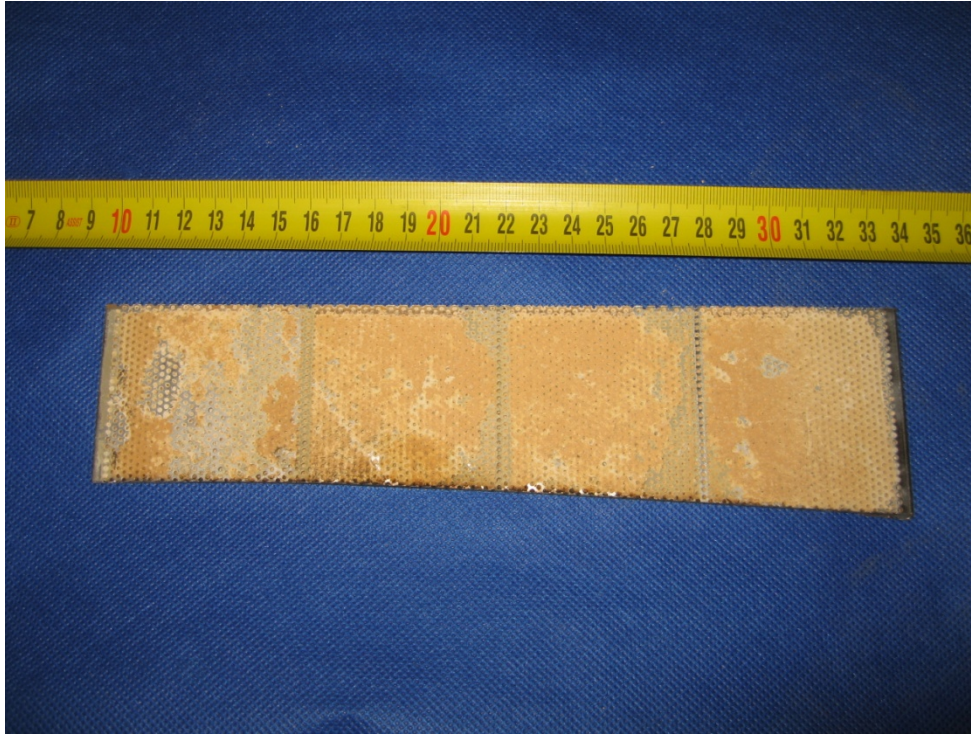
KUVA 2. Saostuman tukkima reikälevyn osa
