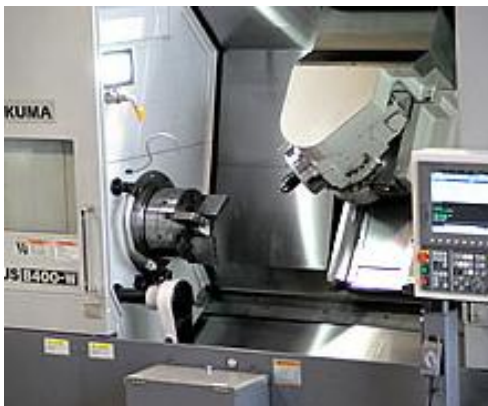
Kuva 8. Kuvassa on moniakselinen sorvi. Kuva www.okuma.com
