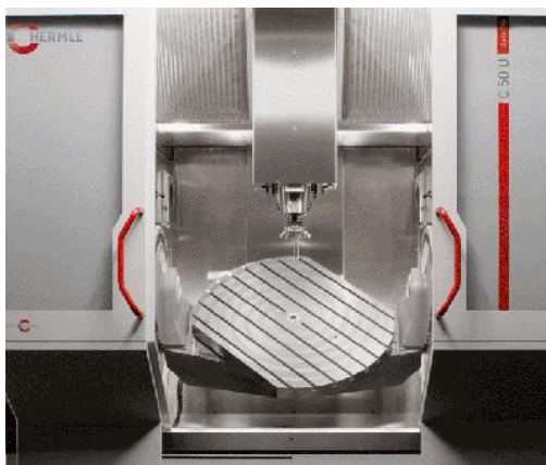
Kuva 16. Kuvassa on tiltipöydällä varustettu koneistuskeskus. Kuva http://www.romatex.com
