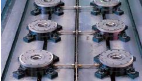
Kuva 19. Kuvassa on nollapistekiinnityksen sylinterit pinta-asennuksessa. Kuva Nollapistekiinnitysteknologioiden soveltaminen ja robotisoitu panostus, Tekes 2011
