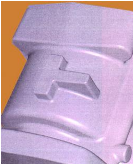
Kuva 25. Kappaleeseen lisätty T-muoto, jonka avulla kappaleen kiinnittäminen tapahtuu yksiselitteisesti, www.valuatlas.fi
