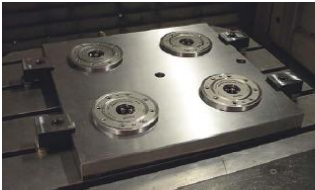
Kuva 20. Kuvasa on nollapistekiinnityksen sylinterit uppoasennuksessa. Kuva Nollapistekiinnitysteknologioiden soveltaminen ja robotisoitu panostus, Tekes 2011
