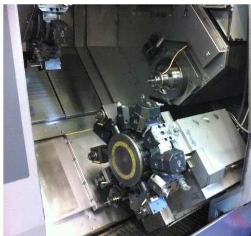
Kuva 11. Kuvassa on alarevolverilla varustettu sorvi. Kuva http://www.exapro.com
