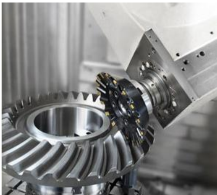
Kuva 2. Kuvassa on kartiohammaspyörän valmistus moniakselisellä työstökoneella. Kuva www.gearsolutions.fi
