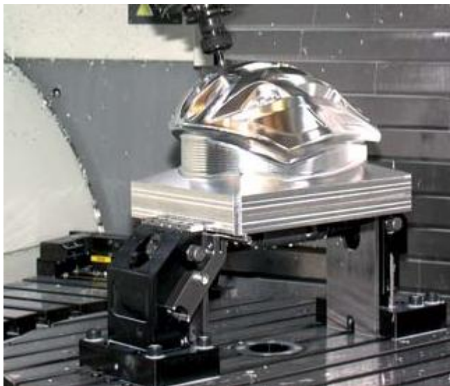
Kuva 247. Kuvassa on koneruuvipuristin, jonka leuat ovat suunniteltu moniakselista koneistamista varten. Kuva http://www.kurtworkholding.com
