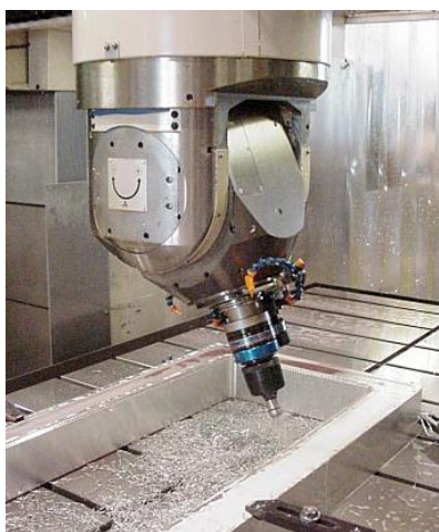
Kuva 4. Kuvassa on universaalipäällä varustettu työstökeskus. Kuva http://www.wagstaffat.com
