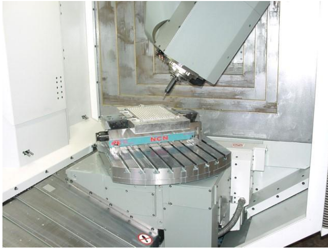
Kuva 17. Kuvassa on pyörivällä pöydällä ja kallistuvalla työkalulla oleva työstökeskus. Kuva www.wadonet.de
