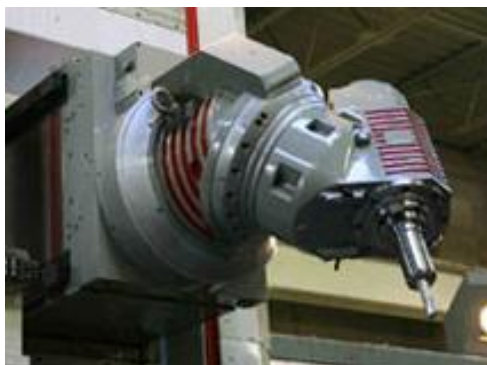
Kuva 15. Kuvassa on metallien koneistamiseen tarkoitettu universaalipää. Kuva www.hunor.com
