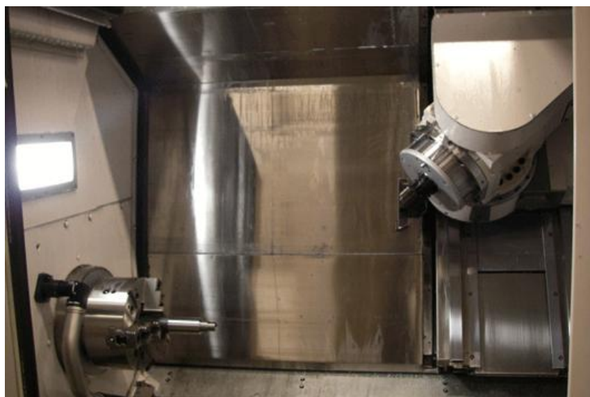
Kuva 9. Kuvan sorvissa on monipuolinen työkalukara. Kuva www.okuma.com
