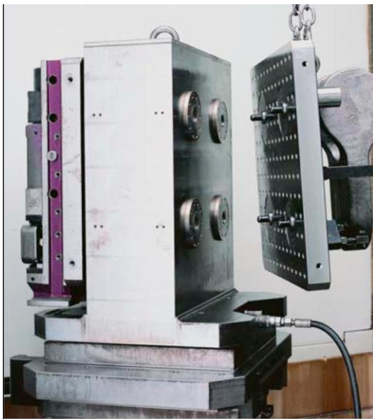
Kuva 23. Kuvassa on nollapistejärjestelmä kiinnitystornissa pystyasennossa. Kappaletta ollaan juuri siirtämässä kiinnitettäväksi. Kuva Nollapistekiinnittimen hyödyntäminen työkalun valmistuksessa ja muovausprosessissa, Lauri Pursiainen 2010, Lappeenrannan tekninen yliopisto
