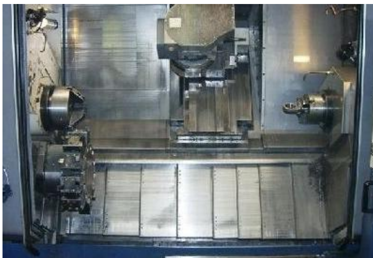
Kuva 10. Kuvassa on kahdella vastakkaisella karalla varustettu sorvi. Kuva www.exapro.com
