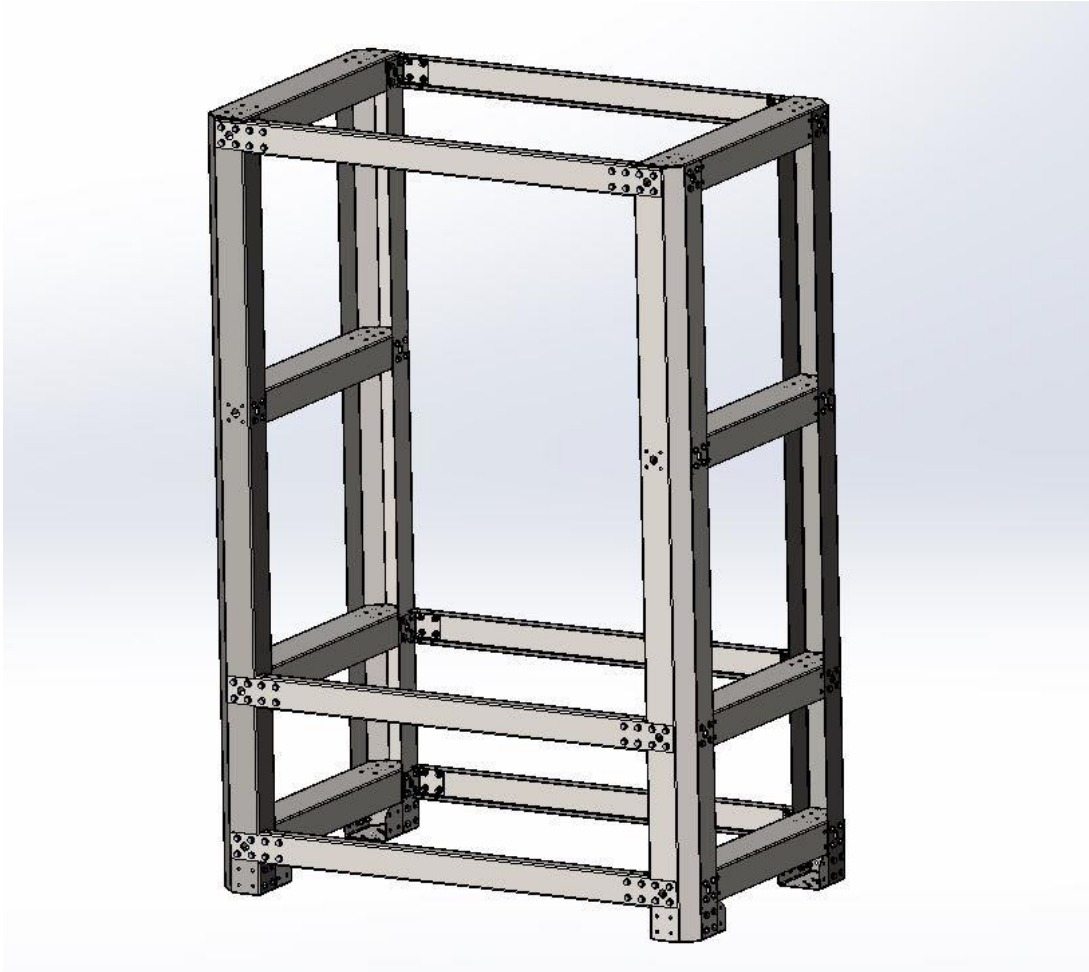
KUVA 26. Modulaarisen peltirunkorakenteen yleiskuva
