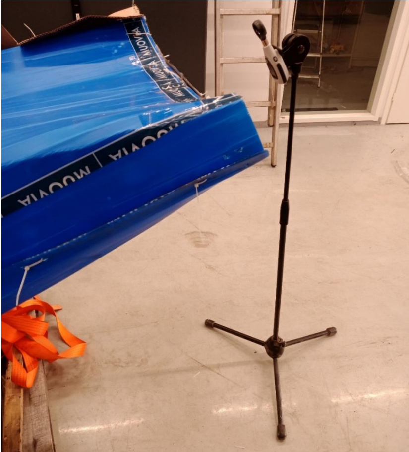
KUVA 16. Ilmavirran nopeuden mittaaminen anemometrillä
