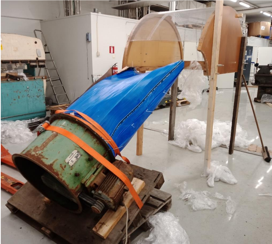
KUVA 15. Muovikalvojen lennättämisen testaaminen kanavapuhaltimella
