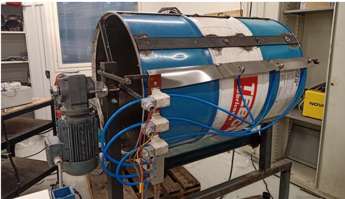
KUVA 11. Ilmaveitsi asennettuna rummun etupuolelle
