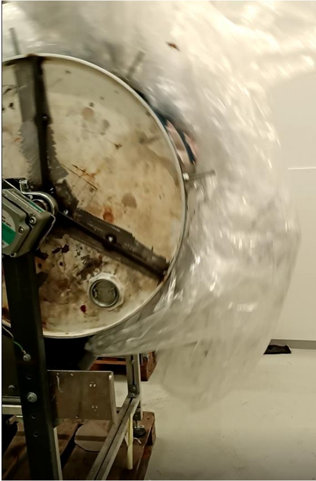
KUVA 8. Kuvakaappaus testivideosta; muovikalvot kiertyivät rummun ympärille
