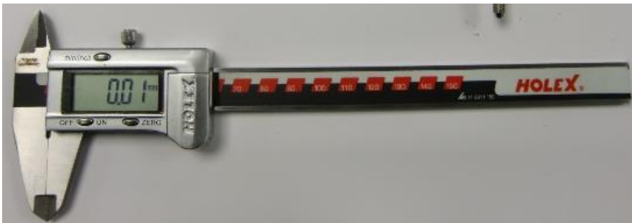
Kuva 10. Työntömitta (Sako, intranet, n.d.).
