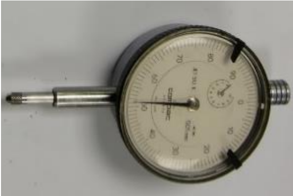
Kuva 9. Mittakello (Sako, intranet, n.d.).
