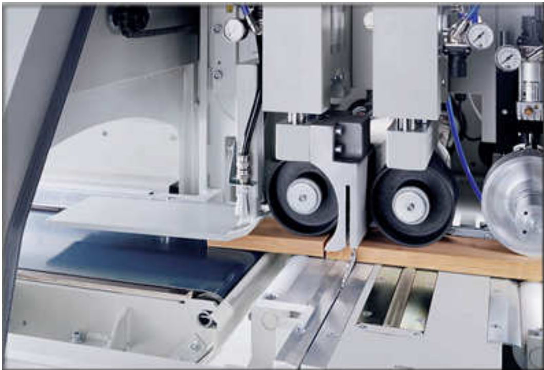
Kuvio 10. Optimoiva katkaisusaha optimoimassa puun mittoja, mutta laitteisto käy myös alumiinin leikkaukseen. (Dimter 2009.)
