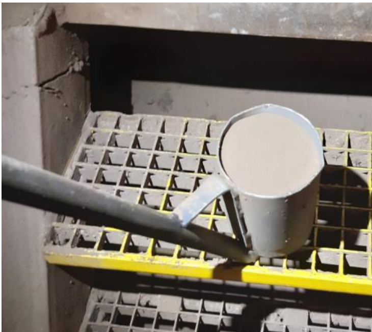
KUVA 17. Näytteenottoastia ja pasutenäytettä astiassa.
