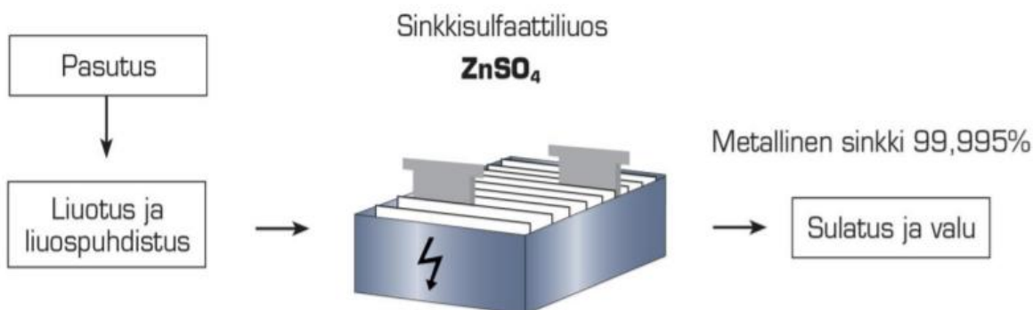
KUVA 4. Elektrolyysin prosessi (Boliden Kokkola Oy)
