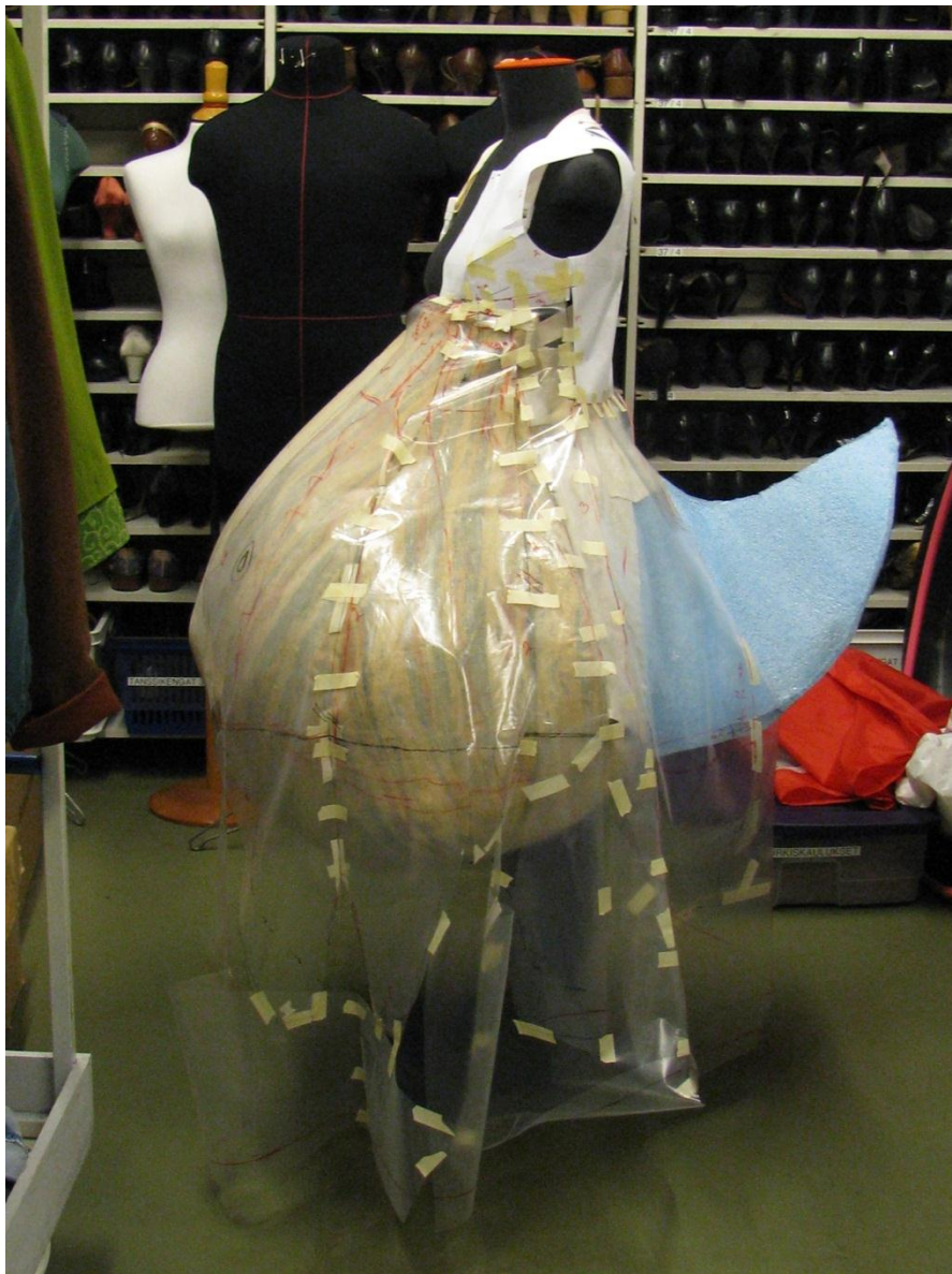
Kuva 40. Mekon kaava muotoiltiin kaavamuovilla röllykän päälle.
