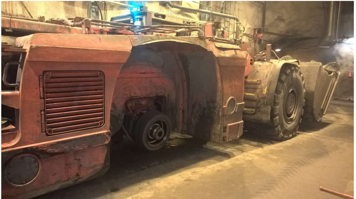
Kuva 6. Lastauskoneen taka-akseliston tumppiakselin katkeaminen. Myöhemmin valmistaja sai vahvistettua akselistoja ja vikaantumiset loppuivat.
