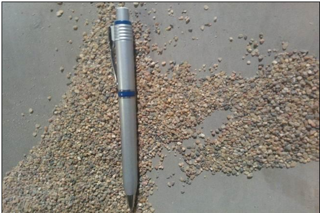
Kuva 3. Hiekkasuodattimessa käytettävää hiekkaa.
