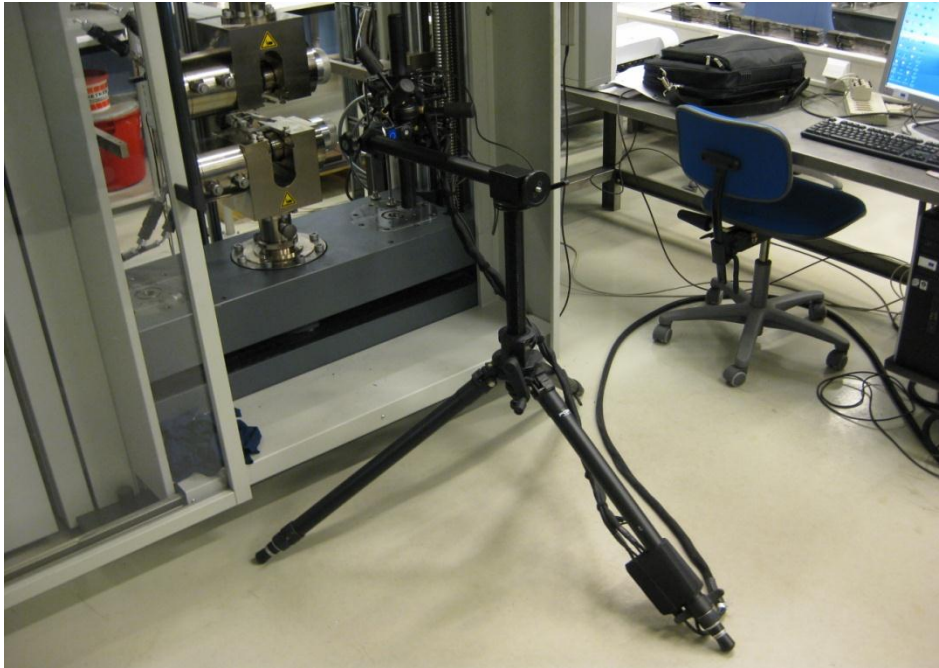
Kuva 2. Vetosauvan kuvaaminen Aramis-kameralla
