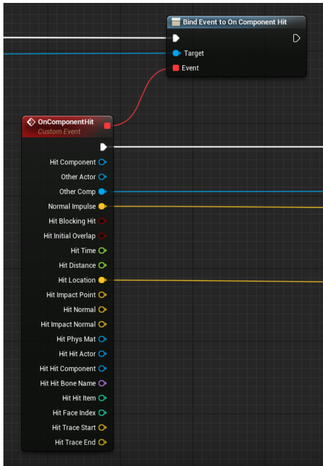
Kuva 14. On Component Hit -event ja siitä saatavat törmäyksen tiedot.
