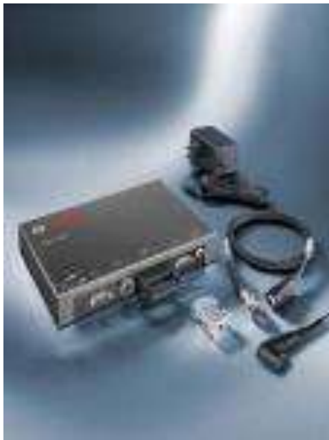
KUVA 6. Bosch BDM300 kierrosluvun mittauslaite magneettipäällä
