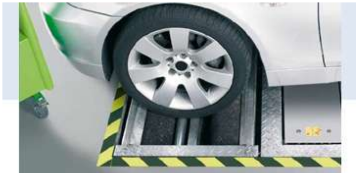
KUVA 8. Bosch BSA 430 4WD -jarrudynamometri ja Bosch SDL 430 -iskunvaimennintesteri
