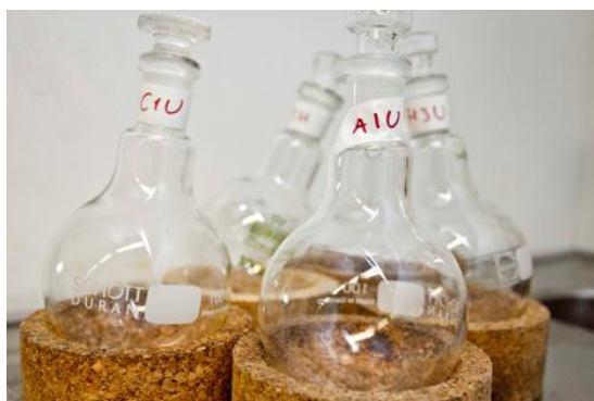
Kuva 13. Haihdutetut keittopullot jäähtymässä vetokaapissa ennen kaasukromatografista ajoa.
