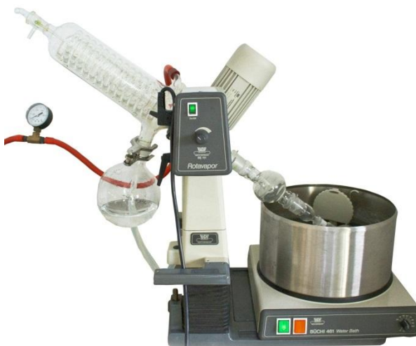
Kuva 12. Työssä käytettiin orgaanisen liuoksen haihduttamiseen Büchi RE111/461 pyöröhaihdutinta.
