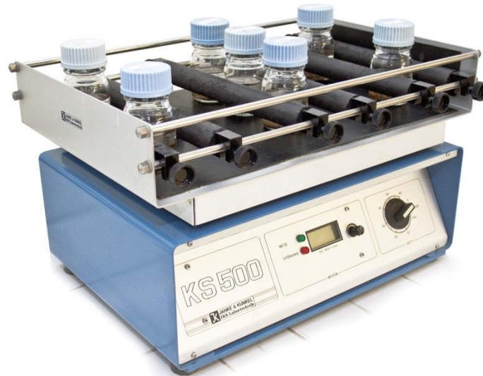
Kuva 11. Mekaanisessa uutossa käytetty laboratoriosekoitin. Laitteella uutettiin aina 7 näytettä kerrallaan ja ne pyrittiin sijoittamaan siten, että paino jakautuisi mahdollisimman tasaisesti.
