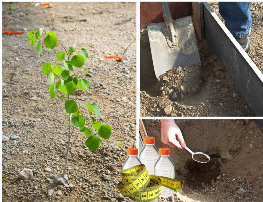
Kuva 5. Näytteenottokuoppa kaivettiin pistolapiolla n. 20 cm:n syvyyteen. Näytteet otettiin elintarvikekauhalla lasisiin pyrex-pulloihin.
