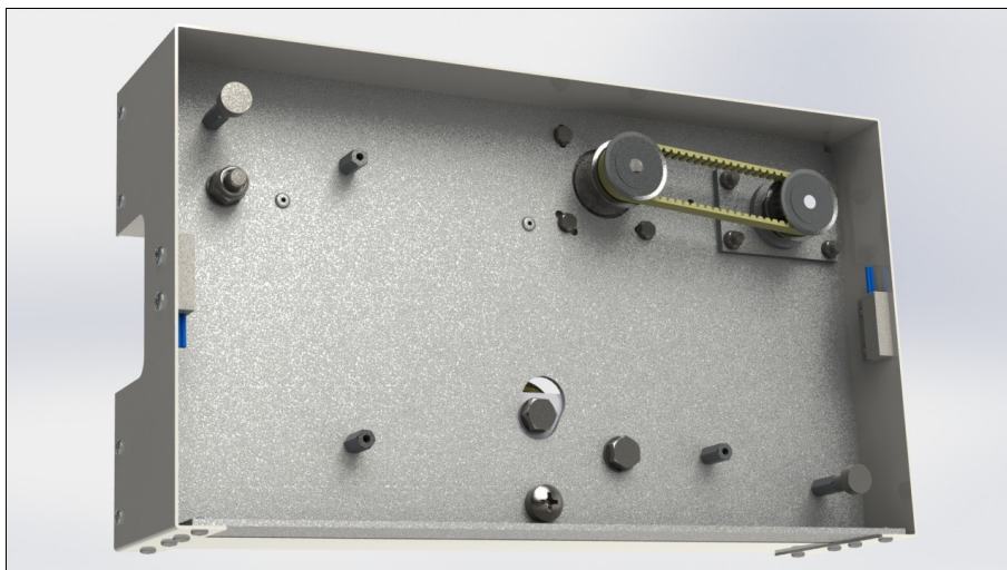
Kuva 7. Kelkan runkolevy, johon on kiinnitettyä muun muassa rullat, moottori, voimanvälitys, piiri- ja etulevyn holkit sekä maalitaulun magneetit
