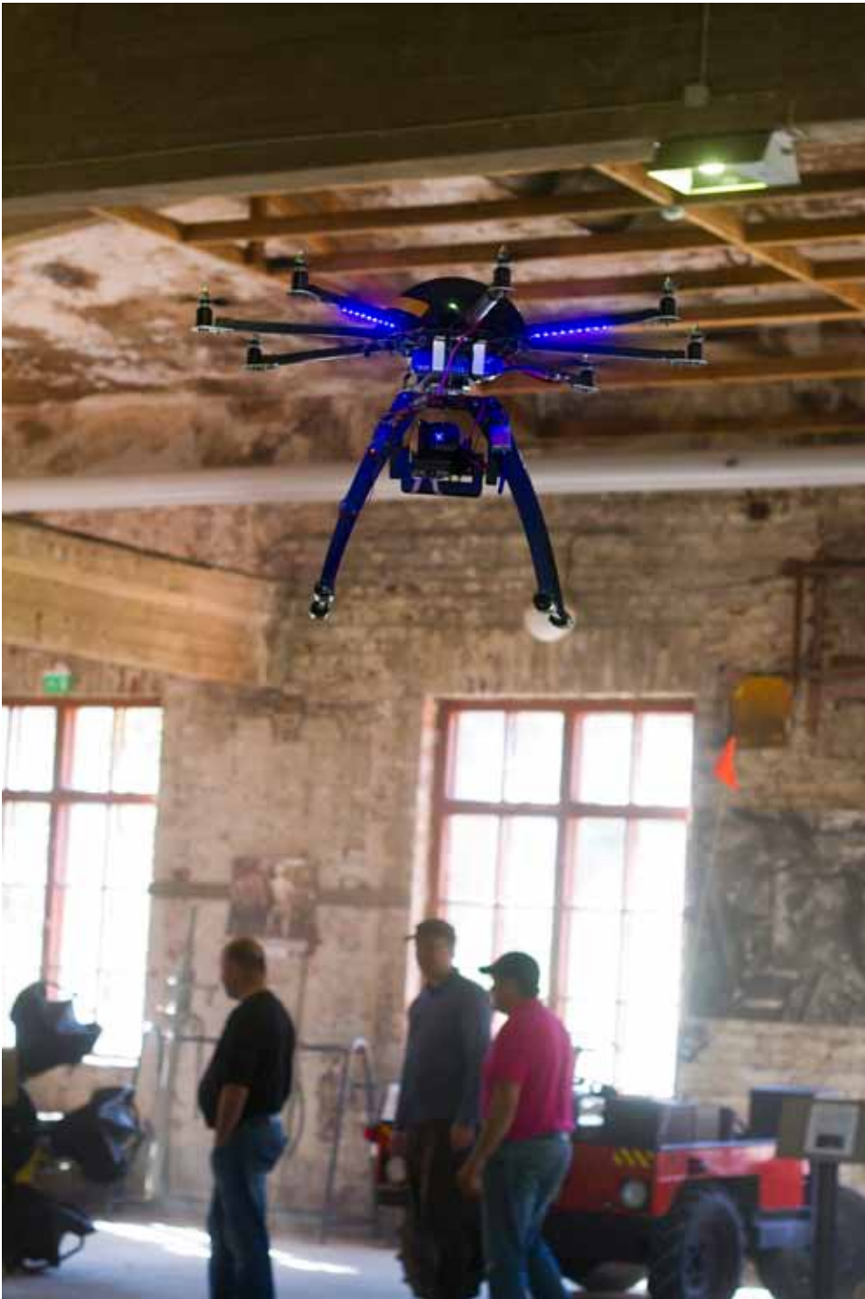
OUTOKUMMUN VANHA KAIVOS OLI HARJOITUSALUEENA VISIOFLYN ILMAKUVAUSKOULUTUKSESSA ELOKUUSSA 2011. STEREOSKOOPPINEN KAMERA OLI KIINNITETTY MINIKOPTERIIN, JOSSA VAKAUDEN TAKAAMISEKSI OLI 8 MOOTTORIPROPELLIA. KUVA: MINNA TAHVANAINEN.
