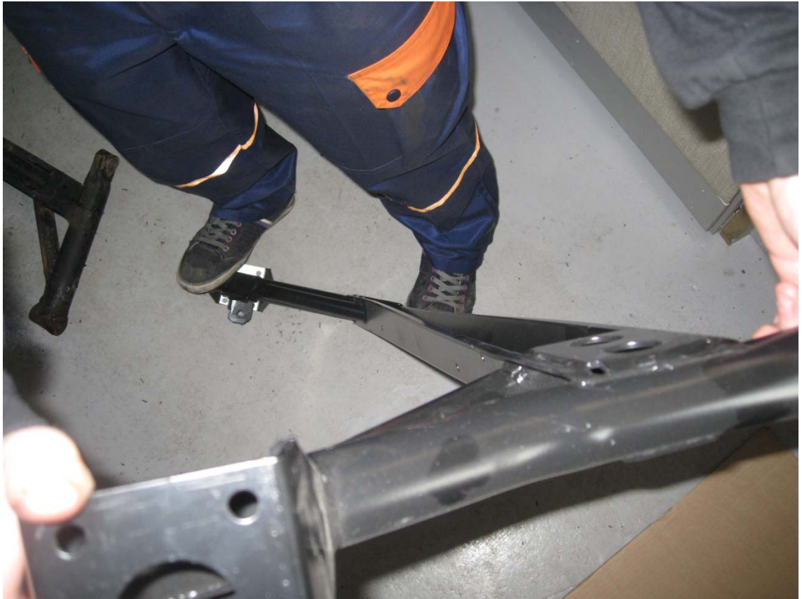
Kuva 8. Alkuperäisen puolijäykän taka- akselin sallima maksimi kierto.
