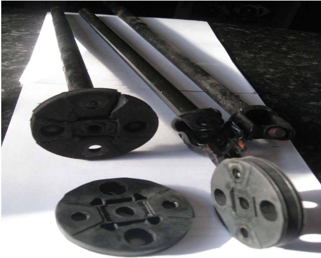
Kuva 7. Ohjausakselin ristikkonivel ja kumi.
