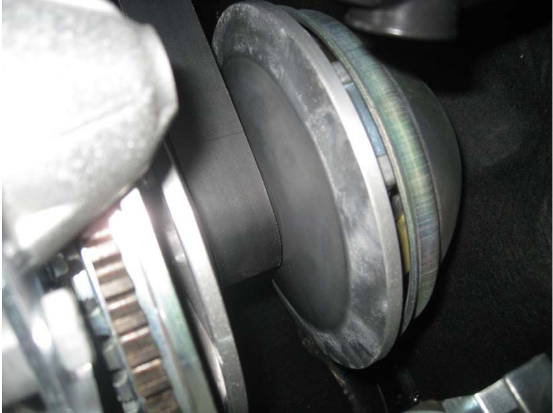
Kuva 13. Variaattorin hihnan normaali nousu
