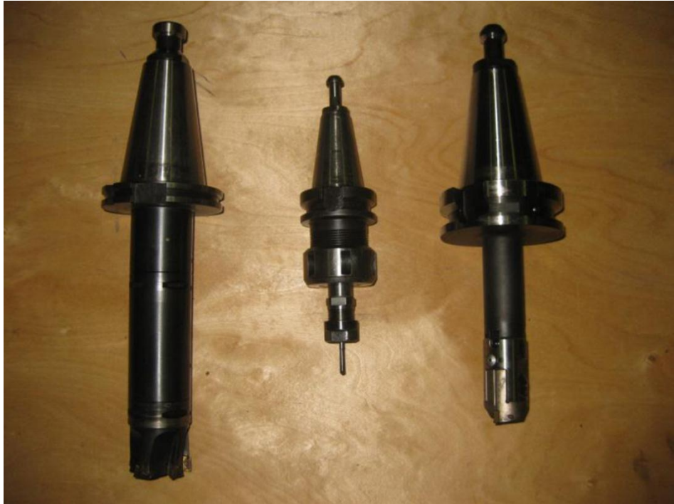
Kuva 15. MTE:n, Mori Seikin ja Johnfordin erilaiset työkalupitimet tässä järjestyksessä (Jalli, 2012).
