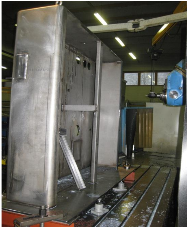
Kuva 4. Noin 1200*1200 mm kotelo jyrsinnässä (Jalli, 2012).
