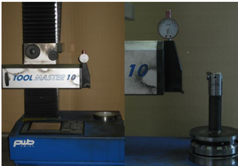
Kuva 14. Työkalujen esiasetuslaite (Jalli, 2013).
