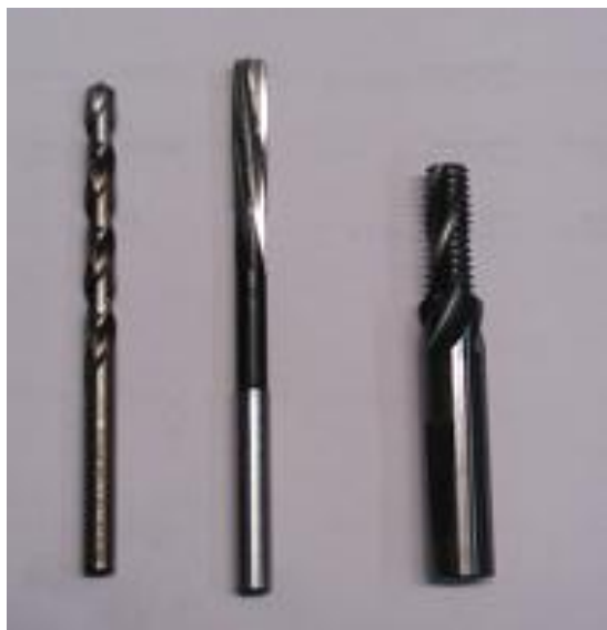
Kuva 11. Kierukkapora, kalvin ja kierrejyrsin (Jalli 2013).
