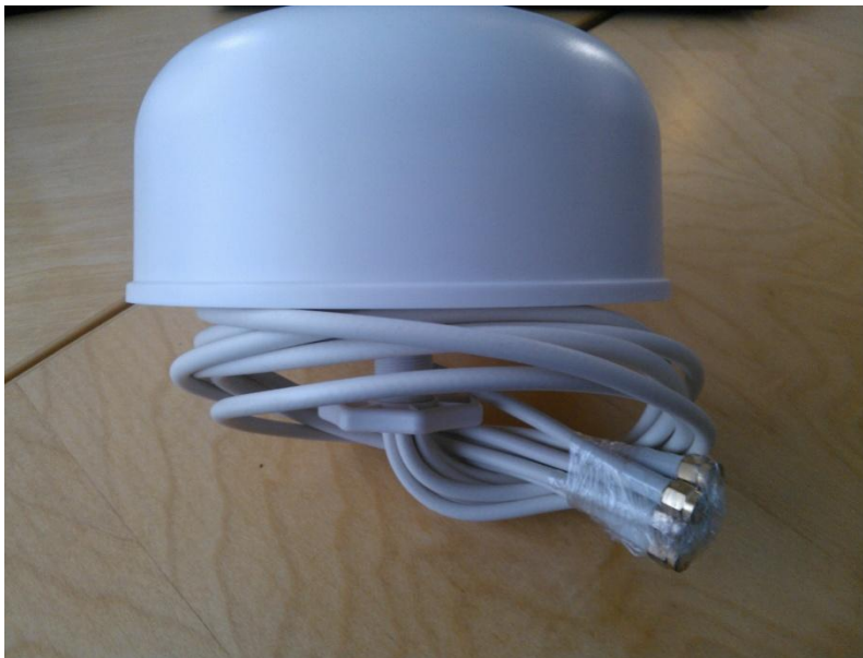
Kuva 11. Kattoon kiinnitettävä 4dBi:n ympärisäteilevä 3 x 3 MIMO -antenni
