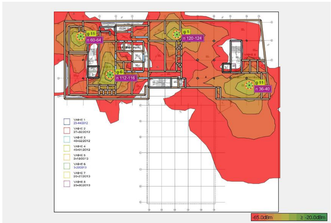
Kuva 17. Simuloidut tukiasemat ja 5 GHz:n taajuuden peittoalue piirrettynä -65 – 20 dBm raja-arvoilla – yläkellari
