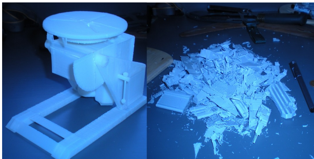
Kuva 23. Tulostettu kappale ja siitä poistetut tukirakenteet
