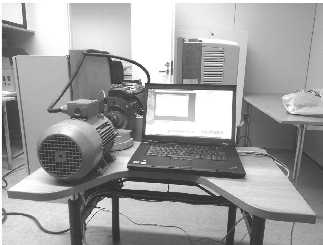
Kuva 3. Etualalla jarruttava moottori, pystylevyjen välissä testattava moottori.
