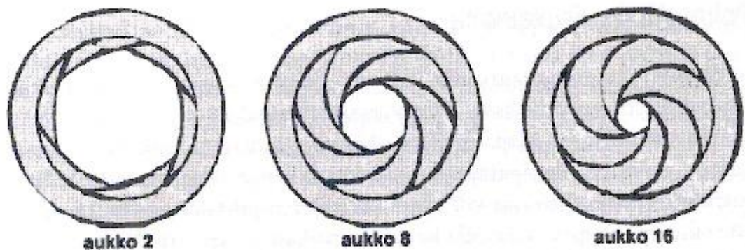
KUVA 13. Aukon toiminta (Korvenoja 2004)
