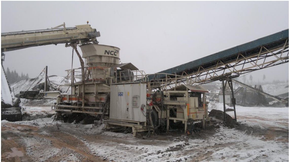
Kuva 6. Välimurskain. Karamurskain on liitetty kuorma- autolla liikuteltavalle alustalle.[10]
