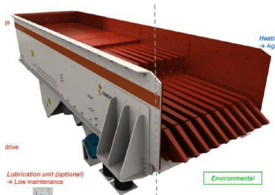
Kuva 3. Metso Oy:n valmistama syötin, jossa nähtävissä myös välppäosa.[9]
