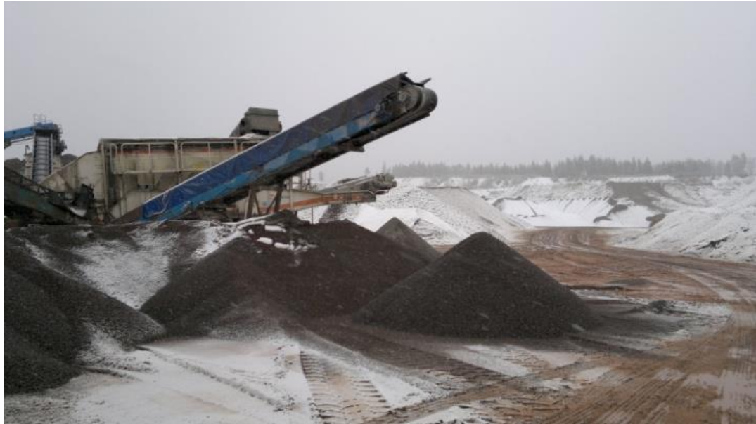
Kuva 9. Loppuseulonnassa tuotetaan kolmea valmista murskelaatua.[10]
