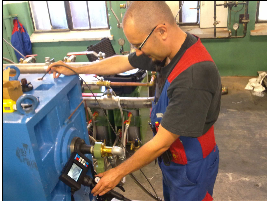
Kuvio 1. Esimerkki ennakoivan kunnossapidon tähytyksestä videoendoskoopin avulla. Tähytyksen kohteena vaihdelaatikon hammaspyörät Nokian Renkailla.
