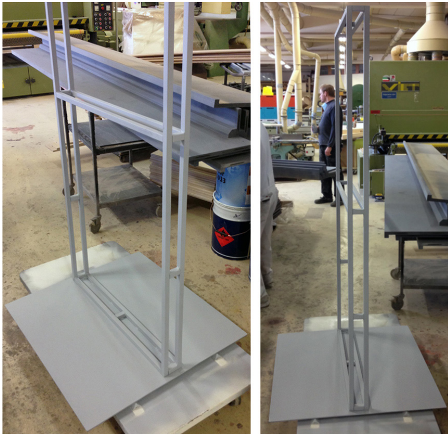
Kuva 26. Keskilattiatelineen teräksinen tukirakenne.
